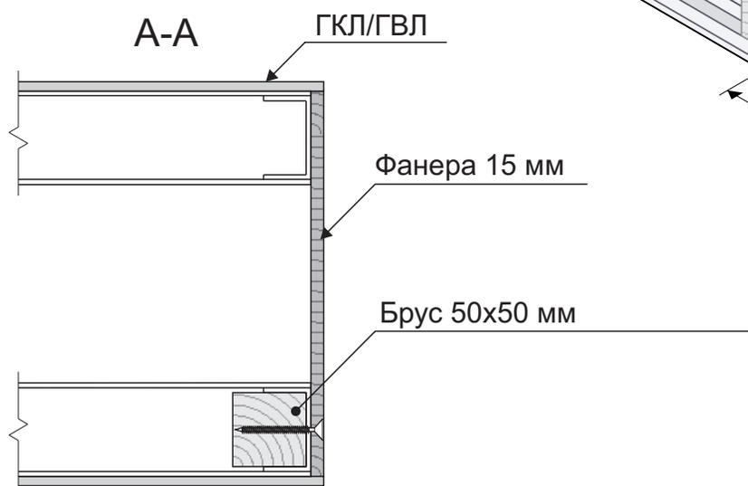
\* размеры в соответствии с таблицами из технических требований по строительной подготовке дверных проемов и помещений. Одностворчатые пеналы к верхней части проёма механически фиксировать не нужно, усиление не требуется. Усиление верхней части проёма необходимо для двустворчатых пеналов.
